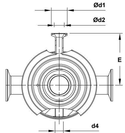
Connexion pour manomètre optionnel
