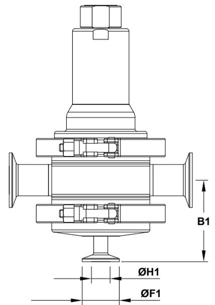
*Couvercle inférieur avec raccord d'évacuation optionnel*
