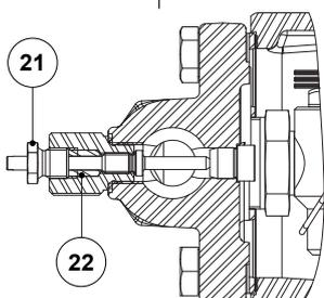
Optional Bypass-Ventil gegen Dampfabschluss (SLR)
