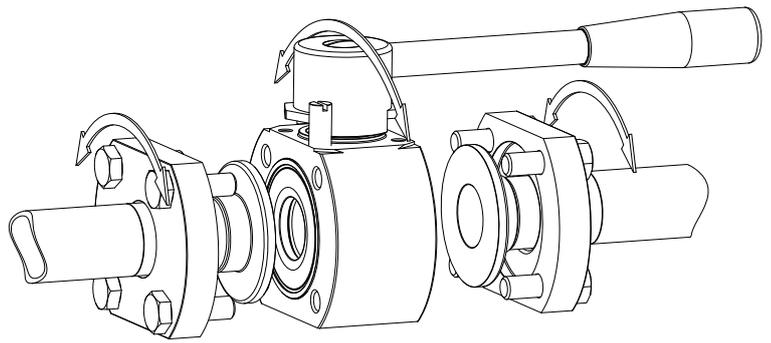
Installation facile et rapide par soudure de tube
