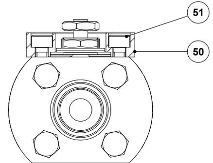
*Montage ISO 5211 en option avec adaptateur de bride (uniquement pour les tailles 1/2" et 3/4" - DN 10 et DN 15)*
