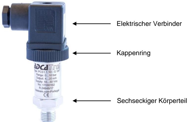
**Hinweis:** Beim Einschrauben des Instruments darf die dazu erforderliche Kraft nicht über den elektrischen Anschluss oder den Kappenring aufgebracht werden. Sie darf nur über den sechskantigen Körperteil und mit einem geeigneten Werkzeug aufgebracht werden.
